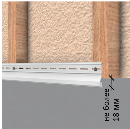
Рис. 12 Установка стартового профиля.
