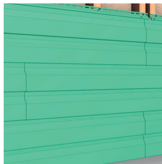
Рис. 25 Смещение стыков панелей сайдинга при стыковке внахлест.
