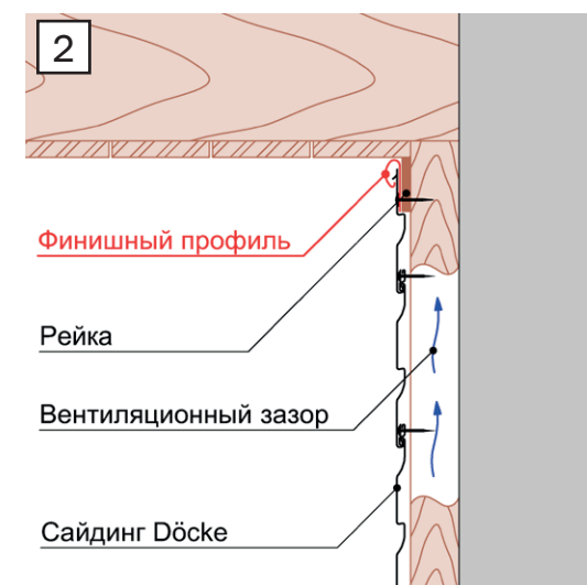
Рис. 26 Примыкание сайдинга Döcke к карнизному свесу при помощи финишного профиля.
